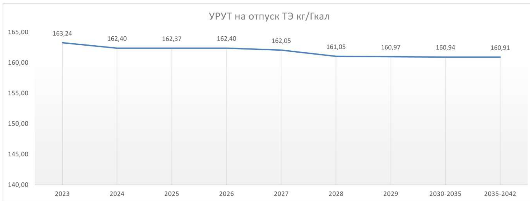
Рисунок 31. Прогнозный удельный расход условного топлива на единицу тепловой энергии, отпускаемой с коллекторов котельных г.о.г. Лыткарино
