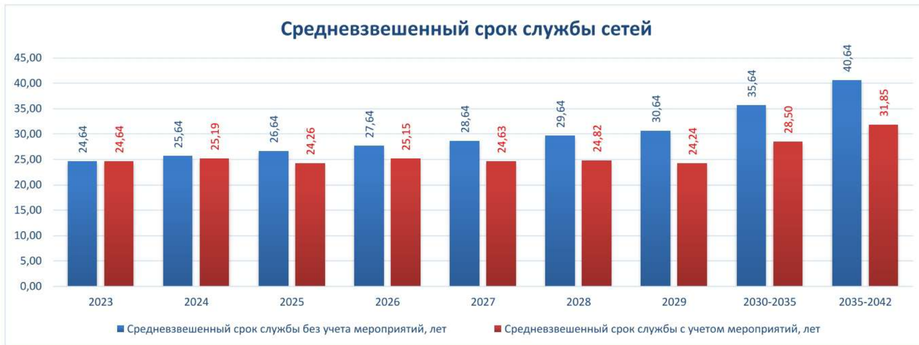
Рисунок 34. Средневзвешенный (по материальной характеристике) срок эксплуатации тепловых сетей с учетом всех мероприятий, предложенных в СТ
