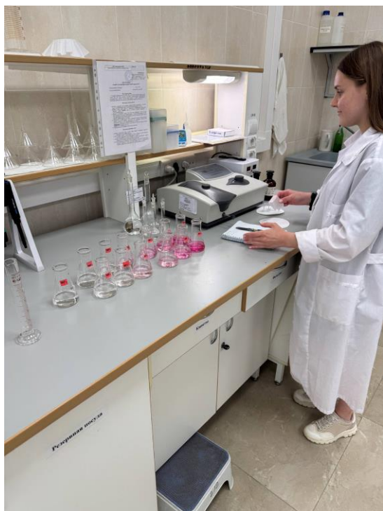
Фото 2 – определение содержания нитритного азота в пробах природной воды
