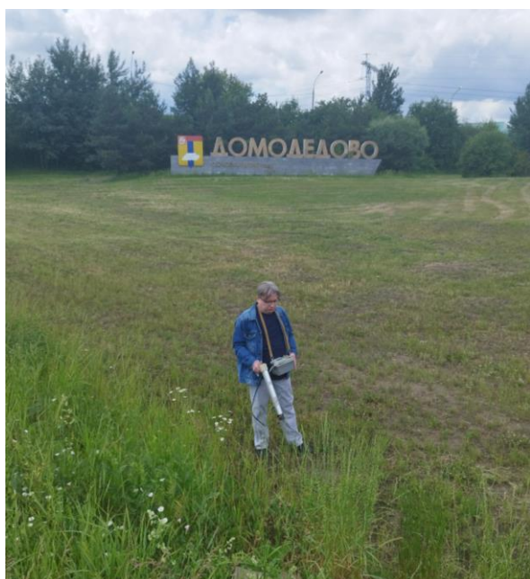
Фото 1 – Измерение МАЭД ГИ в контрольной точке дозиметром-радиометром МКС-151
