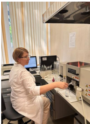
Фото 2 – Определение тяжелых металлов на спектрофотометре АА-6200
