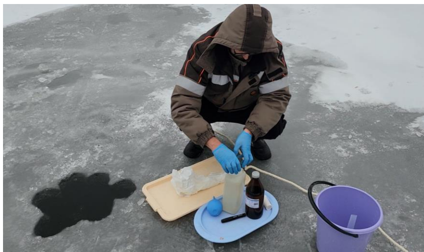
Фото 1 – Отбор проб воды для радиометрического определения удельной суммарной альфа, бета-активности
