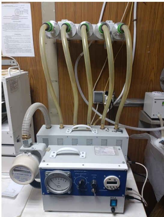
Фото 1 – Пробоотборное автоматическое устройство ПАУ 4 для отбора проб атмосферного воздуха на взвешенные вещества
