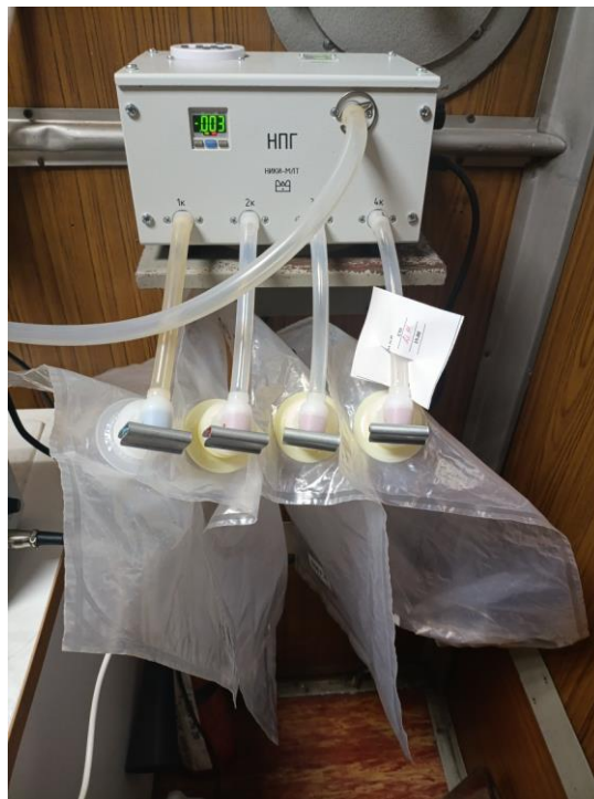
Фото 2 – Наполнитель газовых пакетов НГП 4А для отбора проб атмосферного воздуха на оксид углерода
