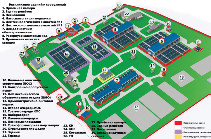
Строительство городских канализационных очистных сооружений г. Лыткарино производительностью 30000 метров куб. в сутки
