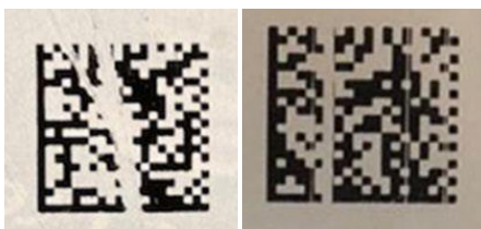
Нарушение целостности КМ*
