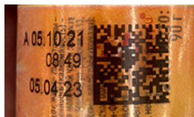
Печать кода маркировки на бликующей/светлоотражающей поверхности
