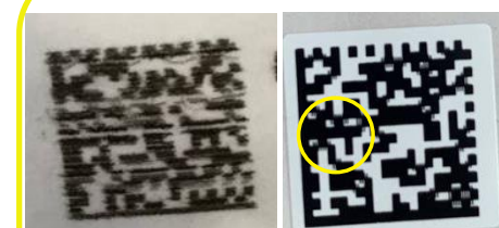
Смазывание кода маркировки или его отдельных элементов
