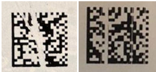
Нарушение целостности КМ*
