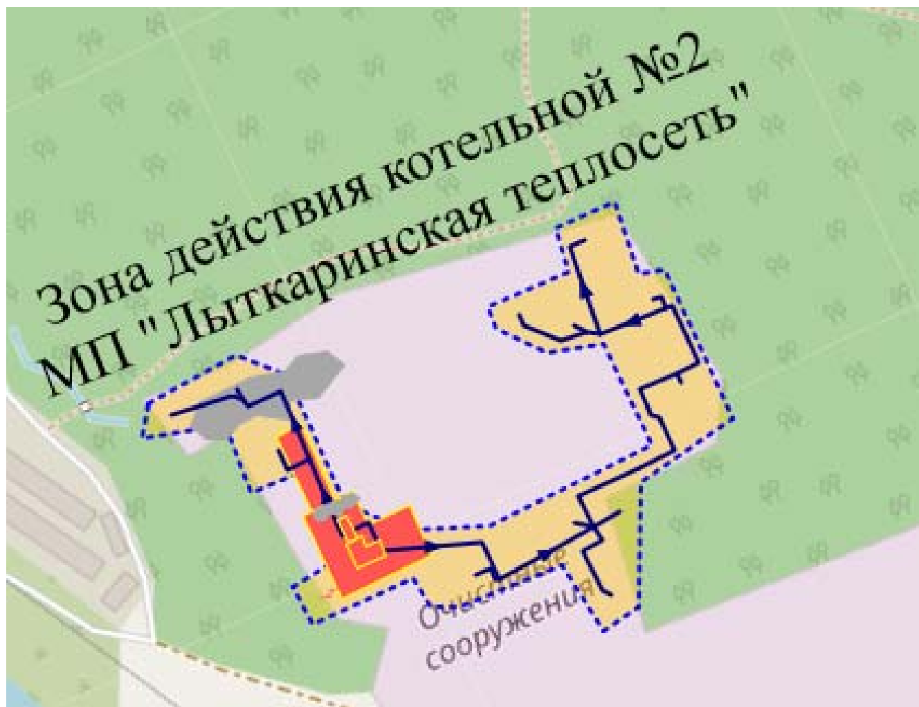
Рисунок 1.2 11 – Зона действия котельной № 2 МП «Лыткаринская теплосеть»
