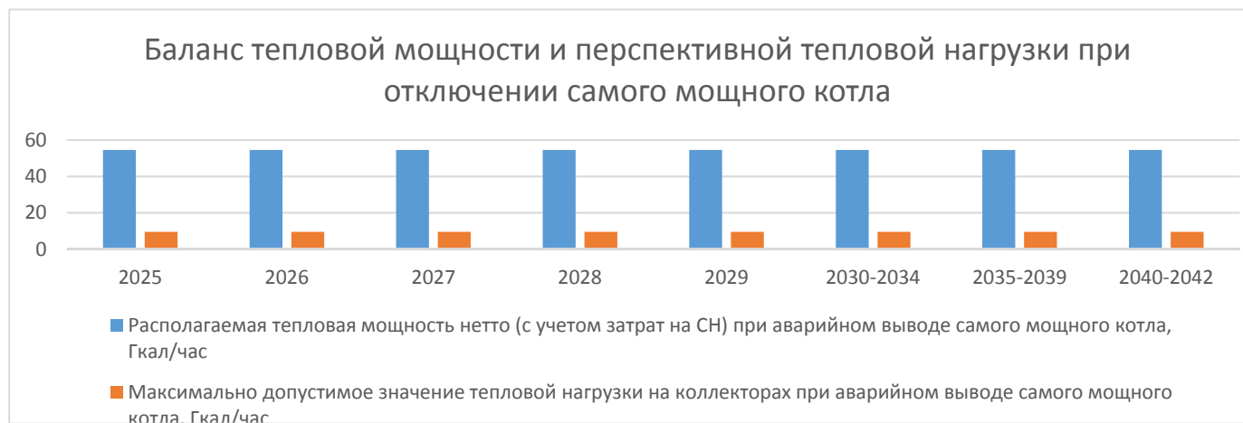
Рисунок 4.1 - 18 - Баланс тепловой мощности и перспективной тепловой нагрузки котельной НИЦ ЦИАМ в аварийных режимах
