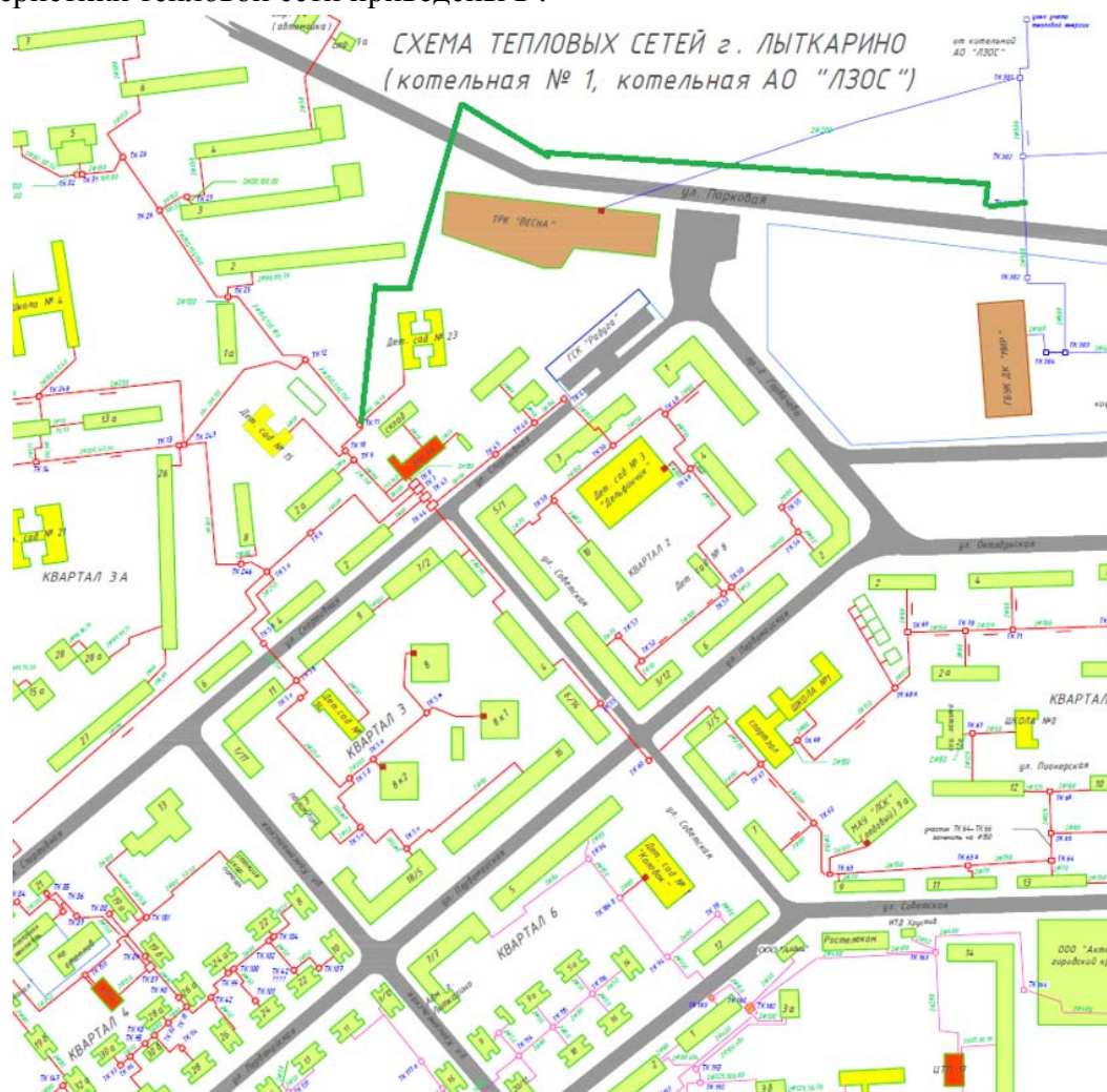
Рисунок 6.5 - 1 - Перемычка между котельными № 1 МП «Лыткаринская теплосеть» и ОАО «ЛЗОС»)
