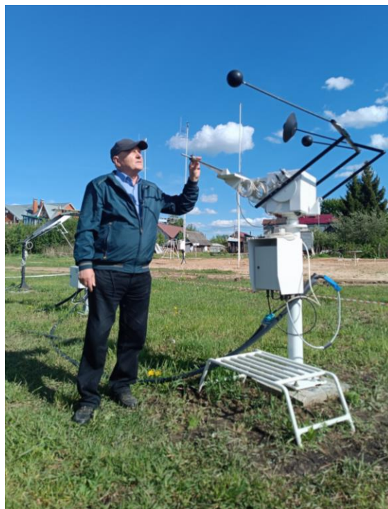
Фото 9 – инспектор ФГБУ «Центральное УГМС» Терешонок Н.А., проверяет систему регистрации прямой солнечной радиации, г. Смоленск
