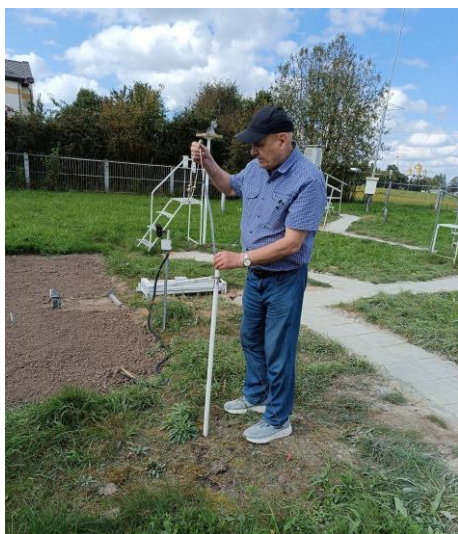
Фото 6 – Настройка мерзлотомера (АМ-21) на М-П Можайск
