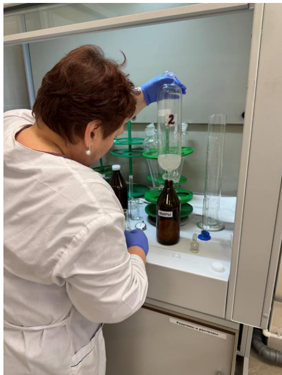
Фото 2 – Экстрагирование пробы петролейным эфиром для определения жиров, ОМПВ ЦМС г. Долгопрудный
