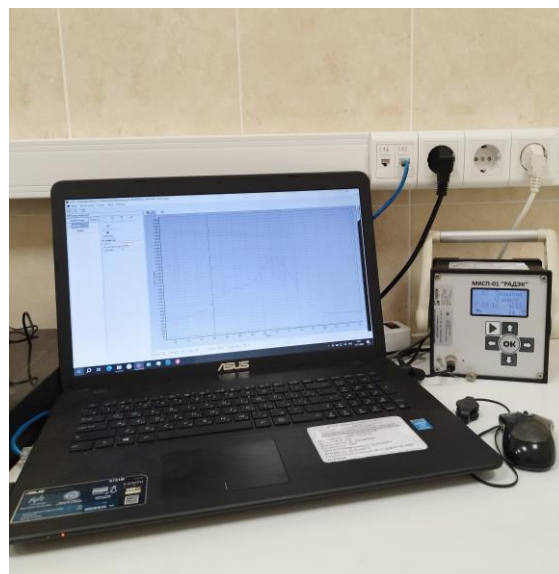
Фото 3 – Спектрометр гамма-излучения МКСП-01 «РАДЭК» для измерения энергетического распределения гамма-излучения и идентификации гамма-излучающих радионуклидов
