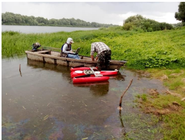
Фото 4 – р. Ока - ГП Половское, измерение расхода воды профилографом, октябрь
